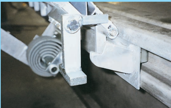
Fallsicherung rastet autom. nach dem Hochziehen der Brücke ein.
