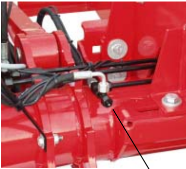
Connexion de contrôle
